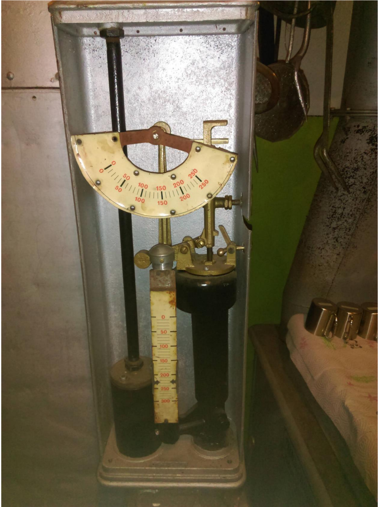
Figure 7 Régulateur du Bois Karre incomplet
