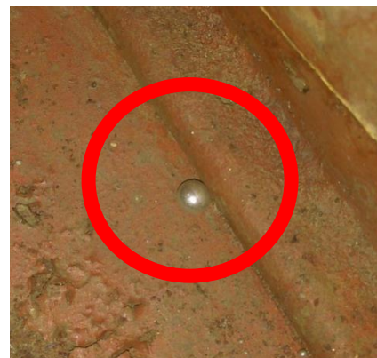
Figure 5 Bille de mercure prouvant la présence de celui-ci dans le régulateur
